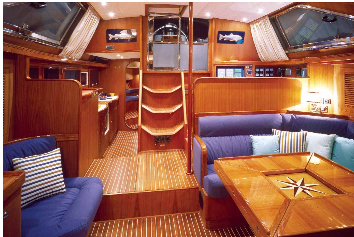
COMPENSATO marino e massello di tek del Siam: sono questi i materiali usati per realizzare i mobili, le cucette e gli armadi.
